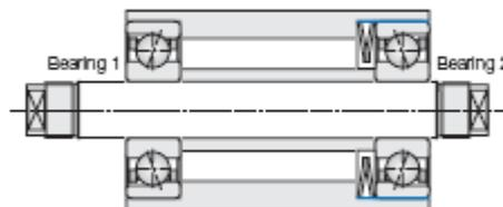
На рис. 1 показан шпиндель в котором подшипник 1 расположен жестко по осевой,
