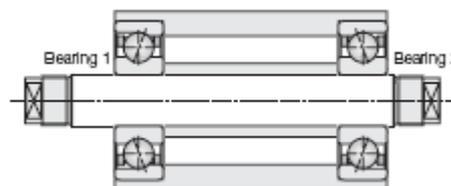
На рисунке показан шпиндель у которого оба подшипника соединены и вмонтированы по осевой стороне. Подшипники с таким расположением имеют осевой преднатяг.
